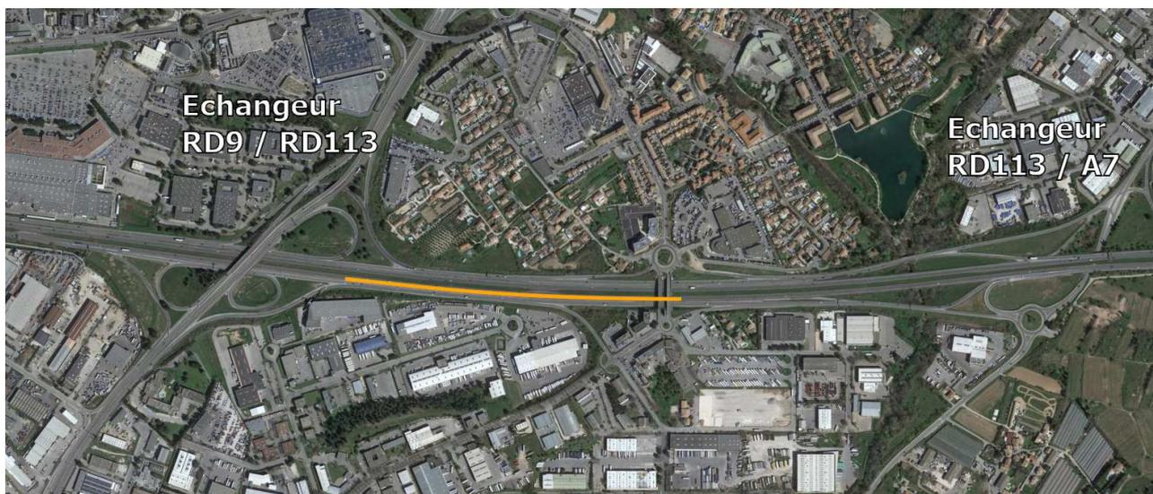
Inscrite au Plan de Relance pour un montant de 455 K€, l'opération consiste à réaliser cette nouvelle voie réservée aux transports en commun moyennant un élargissement de la plateforme autoroutière du côté du terre-plein central dans le sens de circulation Vitrolles-Marseille.
